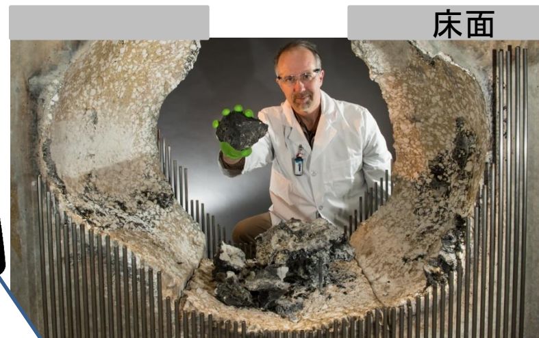
従来のMCCI実験結果 (米国アルゴンヌ研究所webサイトより)
